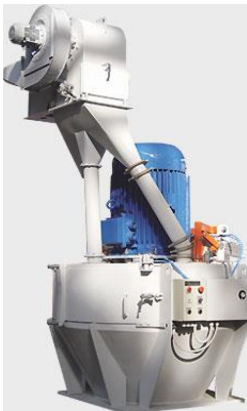
Рисунок 43 - Дробилка ВЕНТА с гравитационным и шнековым питателем
