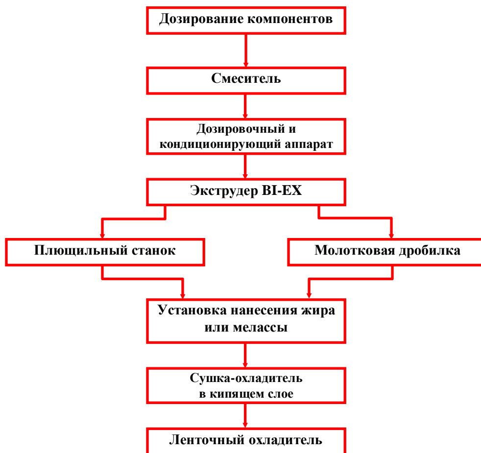
Рисунок 32 - Структурная схема производства экструдированных продуктов с использованием экструдеров типа VI-EX фирмы «Bühler-Bühler MIAG».
